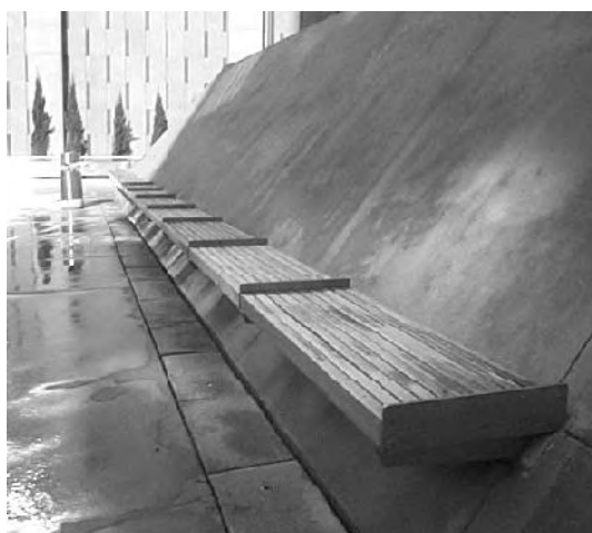
Figura 15: Banco público na Federal Building Plaza, em São Francisco. Desenhados especificamente para afastar os indesejados. O banco não permite que se deitem ou que se encostem confortavelmente.
