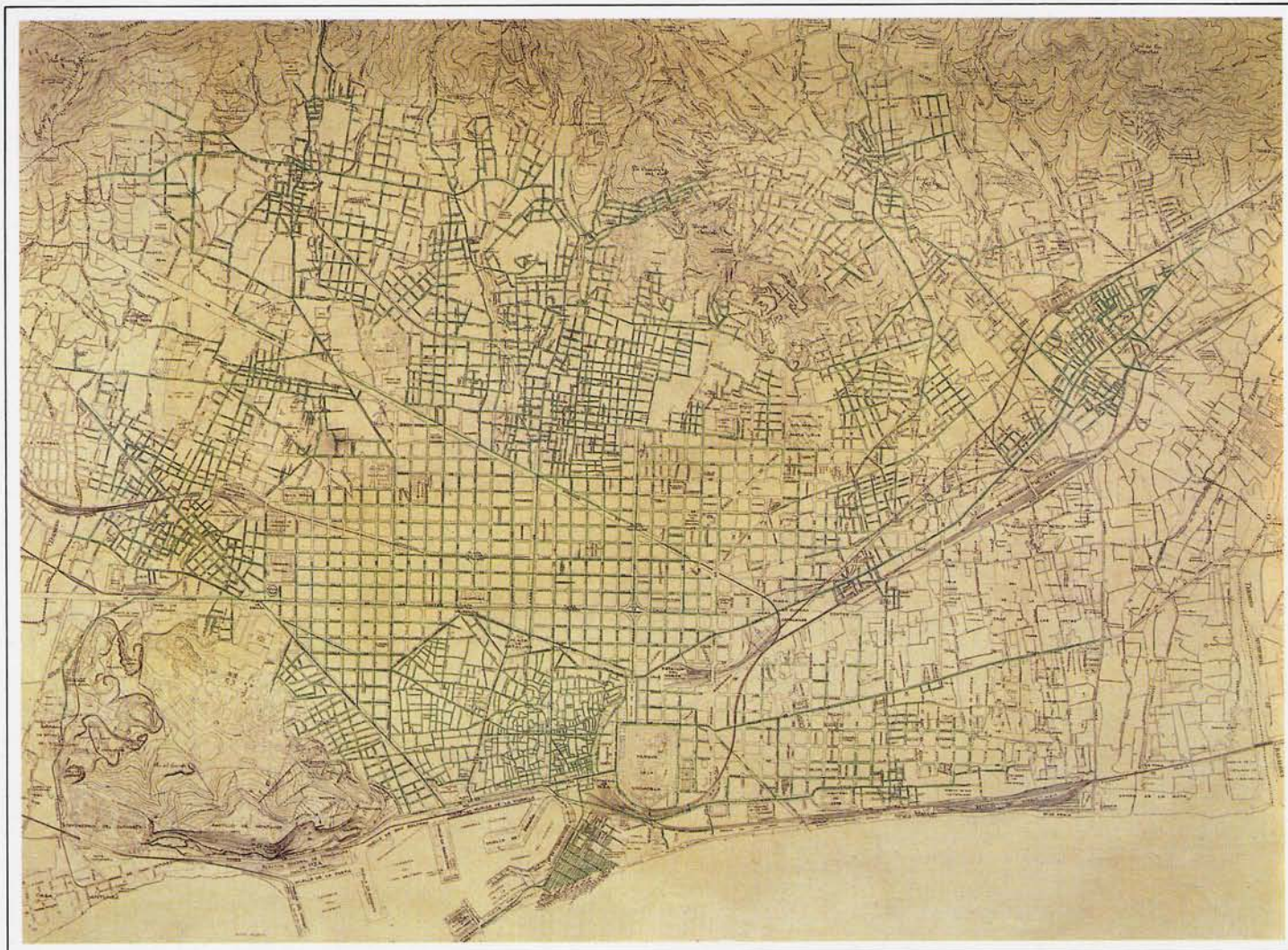
5.12 - Hacia 1929, la práctica totalidad del territorio de la ciudad de Barcelona se encontraba canalizado por las conducciones de gas para el consumo público y privado. Plano de las canalizaciones de la Catalana de Gas y Electricidad.
