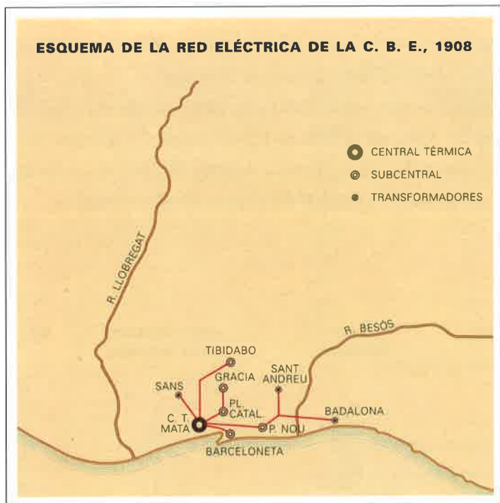
4.9 - Esquema de la red eléctrica de la CBE, 1913. El mapa muestra el desarrollo del circuito de alta tensión tendido en los años 1912 y 1913. El objetivo perseguido era articular las centrales productoras y los mercados de las comarcas del Barcelonès, el Baix Llobregat y el Vallès.
